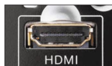
HDMI = High Definition Multimedia Interface, überträgt Bild und Ton digital einschliesslich HDCP
