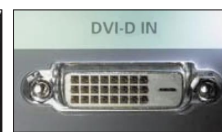
DVI-D = Digital Visual Interface, überträgt nur Bildsignale (digital und analog) incl. Kopierschutz
